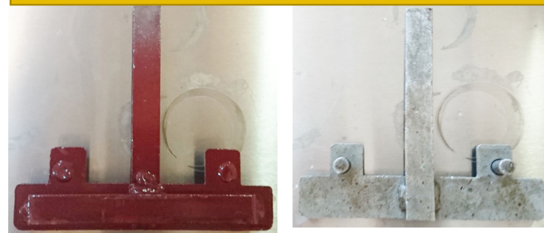
塗装治具の剥離(素材:鋼製)
