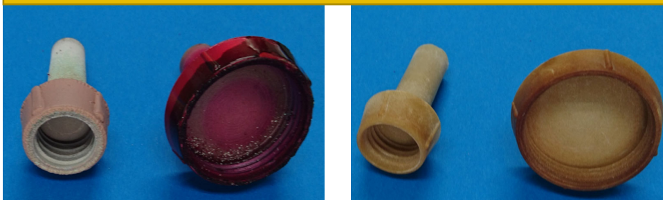
塗装治具の剥離(素材:樹脂製)
